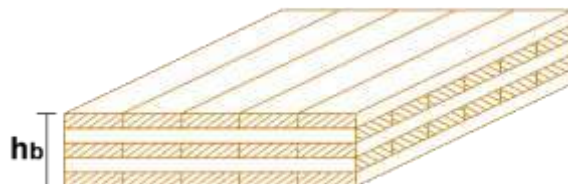
Figura: Grandezze geometriche relative al solaio in XLAM
